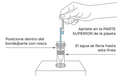
Coloque la pipeta llena dentro del borde/parte con rosca del tubo de ensayo.
